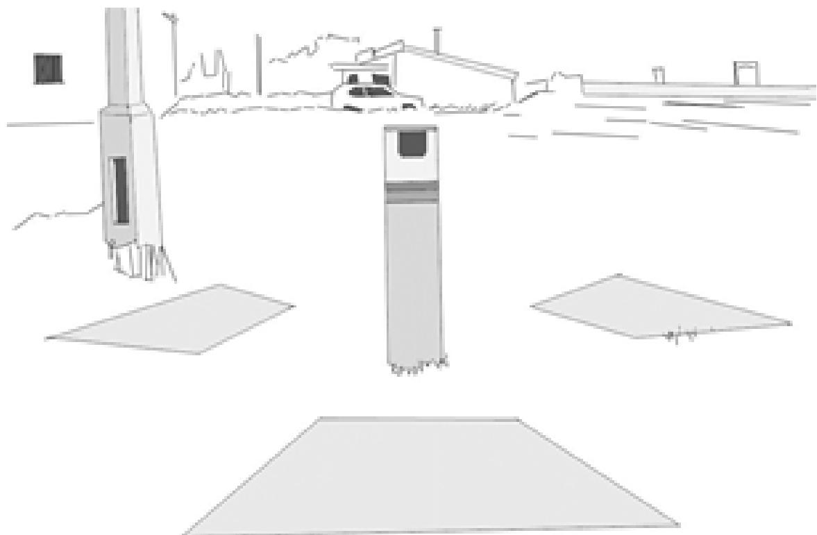
*Рис. 5 Устройство принудительного центрирования (Тур I полигона ЮЗГУ)*
