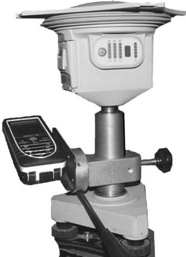
*Рис..4 Лазерный прибор с адаптерами LSA 360, трегера и GPS приёмником*
